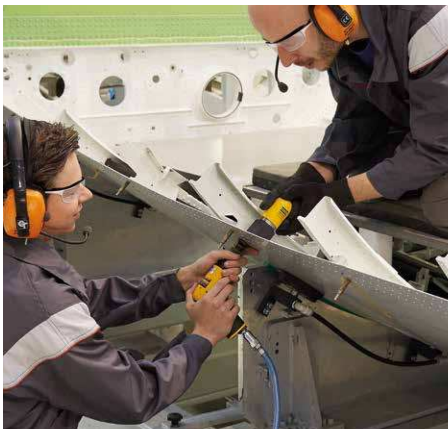
Gegenhalter mit der Bezeichnung SP und als servounterstützte Version mit der Bezeichnung SA.
