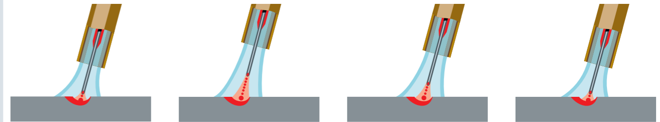
Durch Änderung des Brennerabstandes kann der Schweißer auf veränderte Randbedingungen besser reagieren.
