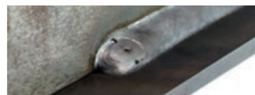
Mit Endkraterfüllung – perfektes Nahtende.
